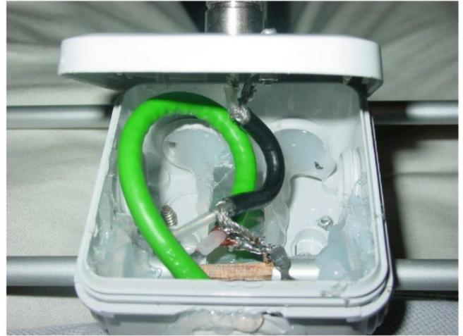
Photo du boîtier Plexo et stub d'adaptation
