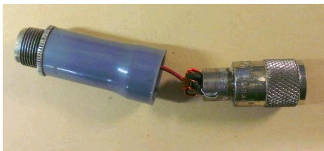
Le petit fil souple a été soudé à la broche centrale de la de la SO239 et celle-ci a été vissée définitivement dans le tube. Le fil "9:1" a été soudé à ce fil souple.
