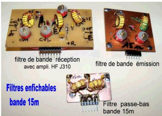
Tous ces filtres ont été testés un par un et confirment les valeurs des bobinages sur tores T50-2 rouge ou T50-6 jaune, des capacités ajustables et capacités fixes, bande par bande de 6 à 160m. Toutes les valeurs sont répertoriées sur des planches spéciales pour les filtres de bandes émission, réception et passe-bas formant une partie de la bibliothèque BINGO.
