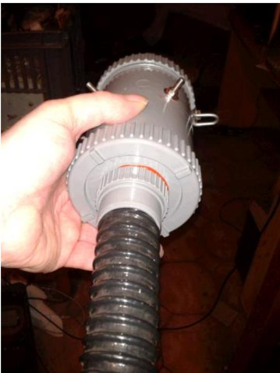
Et voilà le résultat obtenu avec, en dessous, un bout de tuyau flexible pour protéger le départ du coax et sa prise et d'empêcher l'eau de venir la "pourrir" le coaxial. Le tout est, bien sûr, très rapidement démontable pour changer le rapport du balun de 1/1 à 1/4 par exemple ou placer autre balun en changeant simplement le bouchon du bas.
