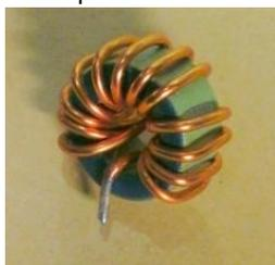
Après quelques mesures, il s'est avéré que ces tores n'étaient pas en céramique mais en poudre de fer et que leur perméabilité était de 75. Après une longue recherche dans les catalogues Micrometals, Ferroxcube, Fair-rite, Philips, etc., nous avons trouvé ! C'était de simples tores Micrometals (Amidon), des T50-42.
