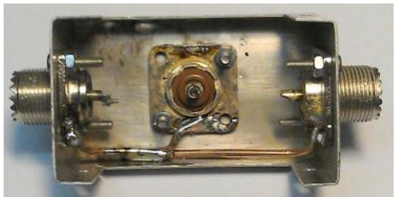
*A g. : les composants. Le switch est un inverseur gros modèle 250V – 10A. Le gros modèle s'impose car il faut un bon espacement entre les contacts pour tenir les tensions HF susceptibles d'être présentes.*
