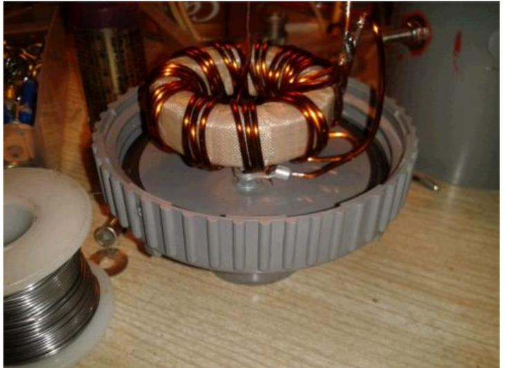
Passage du fil émaillé à travers la plaquette de renfort toutes les vis sont en inox et rondelles cintrées pour épouser la forme du tube.
