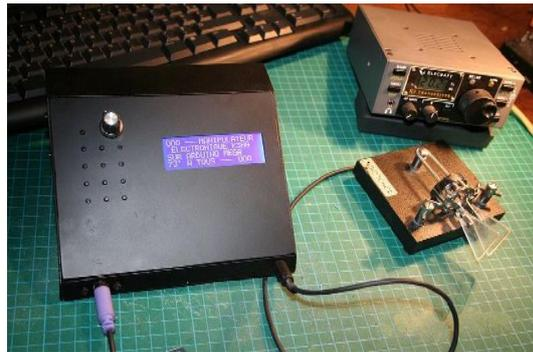
Ce site vous présente en détail la construction d'un keyer basé sur la programmation d'un PIC Arduino. Le schéma est renseigné ainsi que les routines du PIC.
