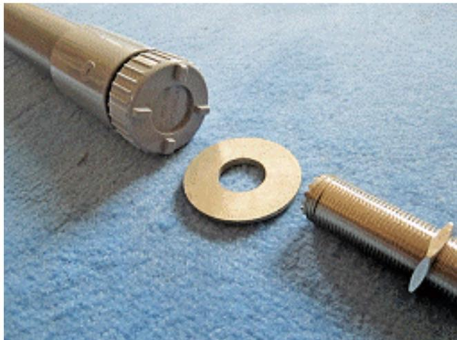
Il faut ensuite supprimer les 4 aspérités en bout du bouchon et le percer au centre au diamètre de l'adaptateur coaxial.
