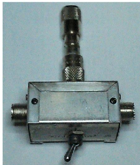
*Le switch monté à son tour. Il est soudé "en l'air" de façon à venir en face du trou de montage percé dans le couvercle. Si on veut brancher deux TX sur le commutateur, on peut économiser deux SO239 en faisant passer deux coax via un passe-fil dans le boîtier et les souder directement au switch. Ces coax iront directement à la sortie des TX.*
