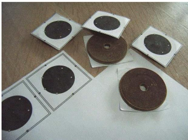
Un logiciel de dessin permettra de tracer un gabarit des points de perçage de la fixation des broches de la self (voir plus loin) . A droite, les gabarits découpés et collés sur les rondelles de fond avec une colle-tout quelconque.
