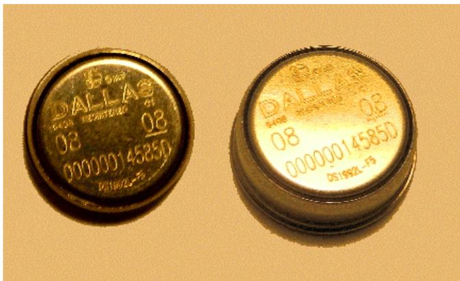
Il s'agissait d'un capteur de température de haute précision fabriqué par Dallas Semiconductor. Il a une plage de fonctionnement allant de  $-55^{\circ}$  à  $100^{\circ}\text{C}$  avec une précision de  $0,5^{\circ}\text{C}$  minimum.
