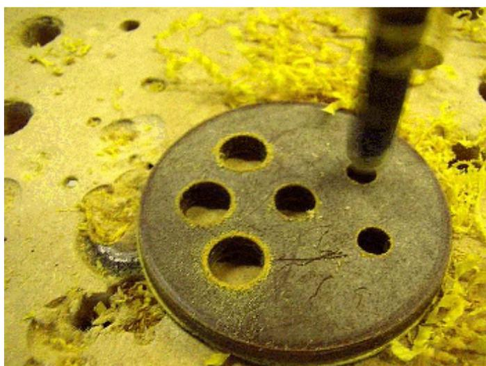
Photos ci-dessus : Un disque identique sera découpé dans de la bakélite afin de réaliser le soquet. A dr. : la mise au diamètre adéquat des différents trous pour le passage des douilles-bananes (voir plus loin).
