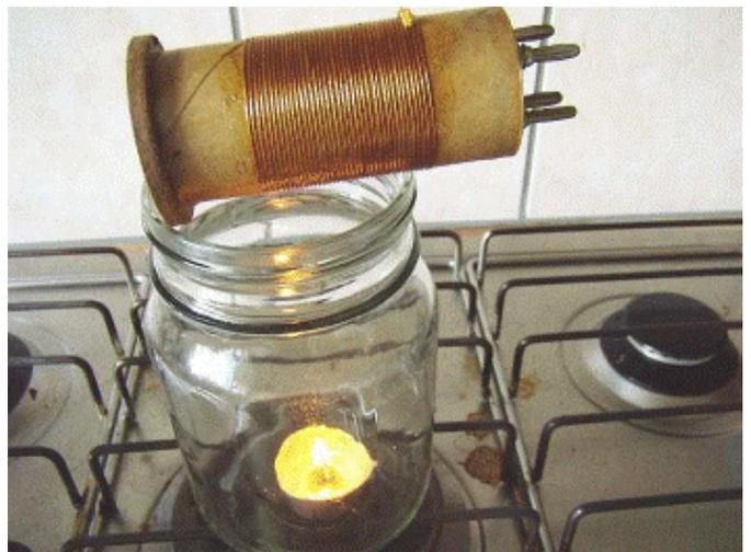
*A g. : une autre vue du bobinage. Il faut vernir l'enroulement afin de le protéger et de le maintenir fermement en place. Cela sera fait avec un vernis classique ou à la gomme arabique ; au choix. A dr., une méthode pour accélérer le séchage. Placez une bougie chauffe-plat dans un bocal et posez l'objet à sécher sur l'ouverture.*
