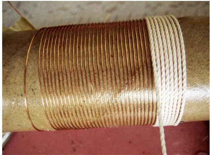
*La confection du bobinage. Jos utilise sa machine à bobiner mais le travail peut parfaitement être fait à la main. Le bobinage est réalisé avec un espacement fixe du fil. Le truc : vous bobinez ensemble le fil de cuivre et une cordelette dont le diamètre correspond à l'espacement des spires. Lorsque le bobinage est terminé, il suffit d'enlever la cordelette.*
