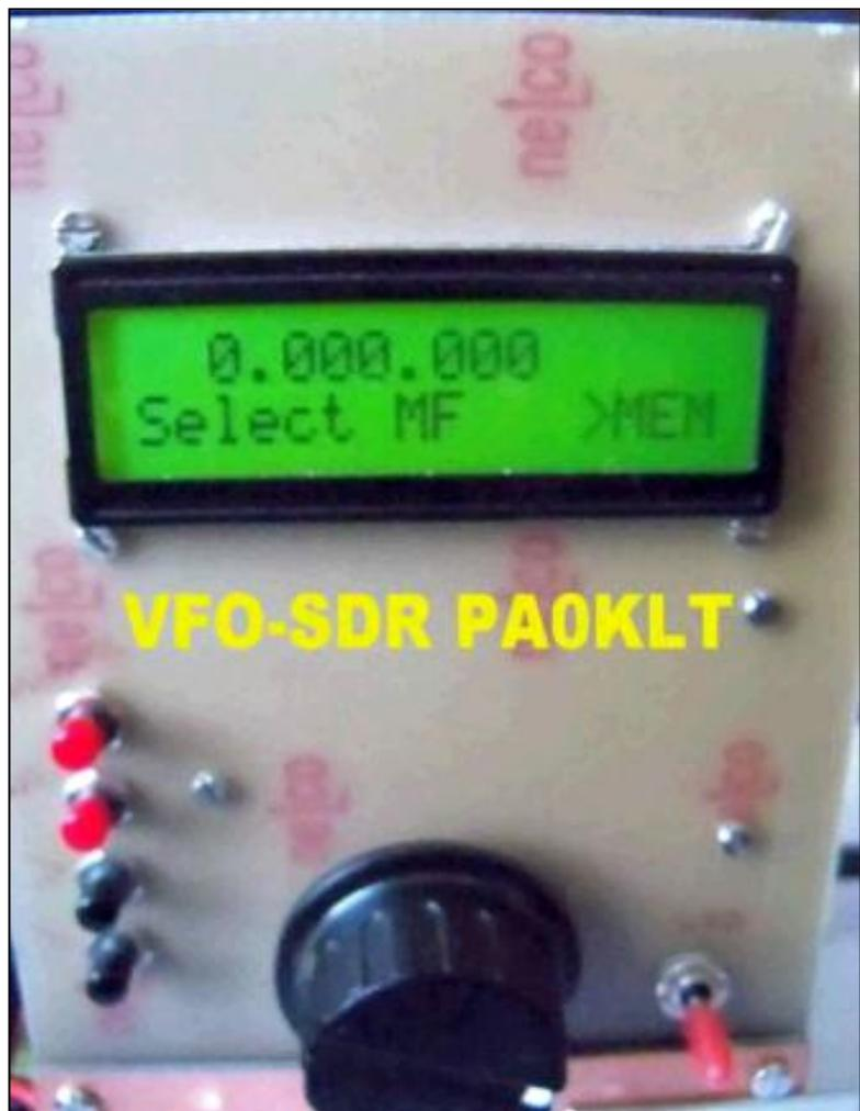
Notre choix se porte sur le premier modèle SI570 C/MOS. Celui-ci oscille jusqu'à plus de 160 MHz et génère directement les 10 mW HF nécessaires à l'injection HF de l'oscillation locale dans le récepteur SDR-DR2.
