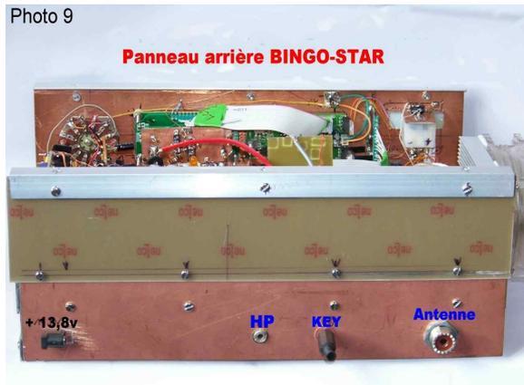
La construction des transceivers BINGO a commencé à partir de l'année 2005. Les toutes premières versions construites étaient sur le principe du transceiver mono-bande, montage en l'air, selon la méthode de câblage appelé par les Américains Ugly. À partir de 2006 avec le nouveau GÉNÉRATEUR BINGO, le circuit imprimé s'est généralisé sur tous nos modèles.
