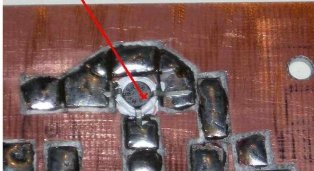
Le BFR96S est inséré dans le trou rempli au préalable de graisse silicone et ensuite soudé. Cette méthode de construction assure un refroidissement énergétique du
