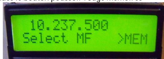
Le sous menu "Select MF" s'affiche à la place de 10.237.500 qui est la F.I. ou Offset du transceiver de F6BCU le chiffre 0 ou 000 Offset = 0 ( Zéro)
