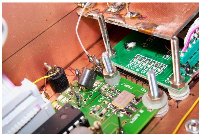
l'utilisation des nappes de fils et des supports tulipe. La deuxième photo de droite, donne une vue de la puce SI 570, est également visible une ferrite binoculaire BN 43 24 02, qui est le circuit de sortie HF sous une impédance d'environ 50 Ohms.
