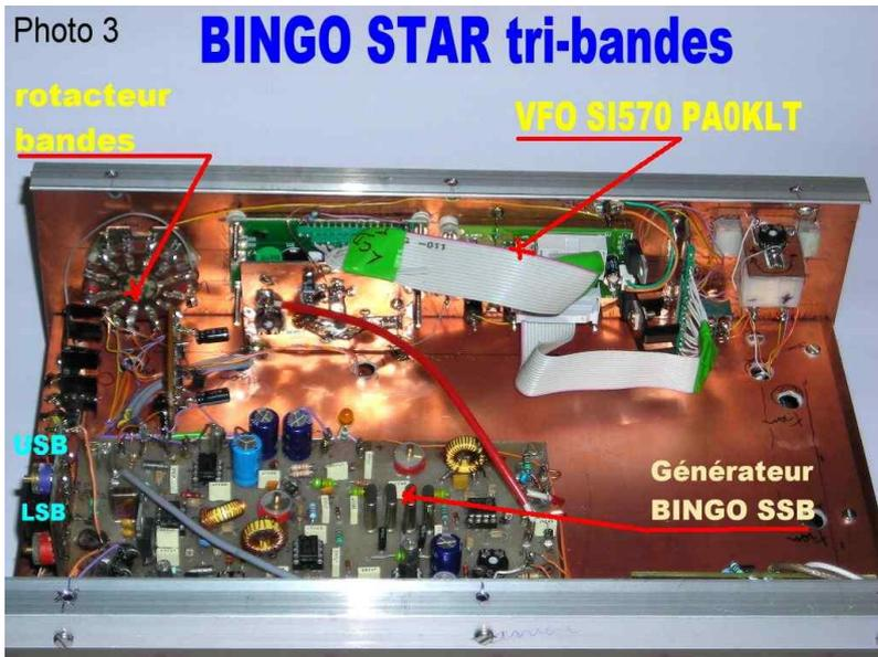
Toutes ces photos vous donnent déjà une idée de l'implantation des circuits imprimés et des composants utilisés. Mais il reste de l'espace pour travailler facilement avec l'avantage d'utiliser des plaques d'époxy cuivré double face aux dimensions standards de 20 x 30cm
