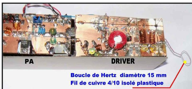
Alimenter le PA sur la connexion + 13,8 volts en permanence et insérer en série dans la connexion un appareil de mesure, sensibilité 10 A.
