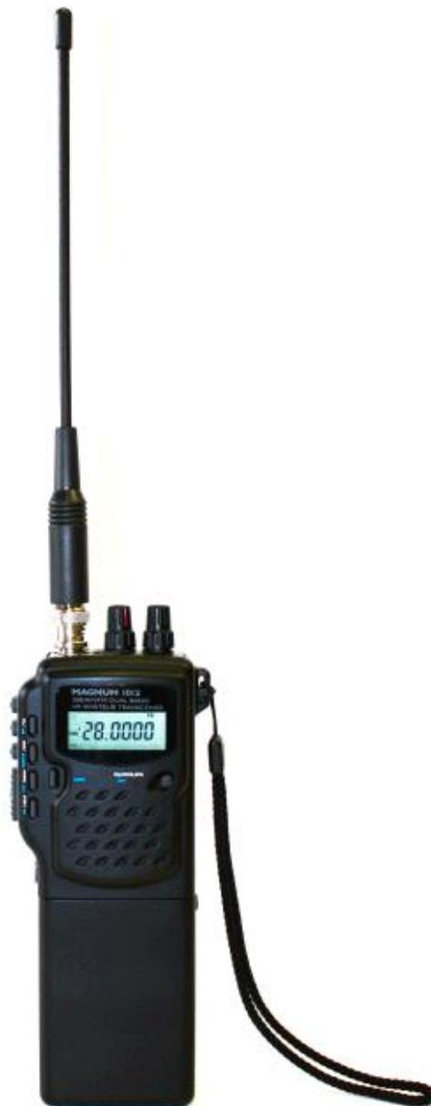
Bien que prévu pour être alimenté par 9 éléments AA (pile ou batterie), le Magnum 1012 peut aussi être utilisé en mobile au départ du 12V de la batterie du véhicule. Une fonction d'économie d'énergie automatique permet de prolonger le temps d'utilisation. Un clip de fixation pour ceinture et une dragonne facilitent l'utilisation en portable.
