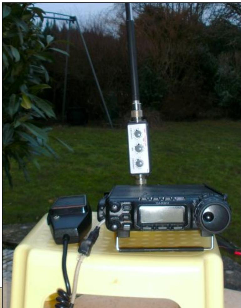
L'avantage de ce système par rapport au système "Miracle Whip" est qu'il accorde réellement l'antenne. Celle-ci résonne donc sur votre fréquence de travail. Autre avantage, et non des moindres pour certains récepteurs, est qu'il agit en *présélecteur* pour votre RX. Ca veut dire qu'il atténue un peu les stations (broadcast ou commerciales) des bandes adjacentes en apportant une sélectivité supplémentaire avant l'entrée de la HF dans le récepteur. Ce n'est pas négligeable.
