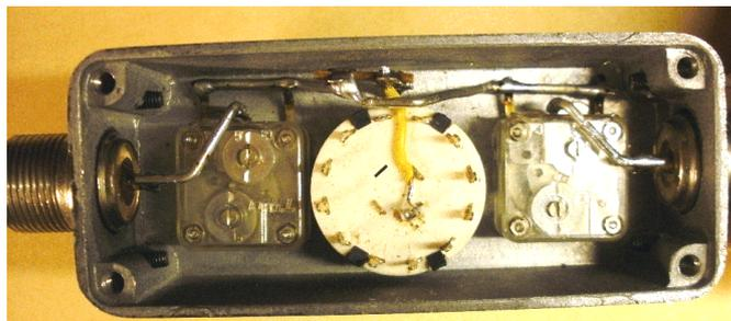
Le montage avant la soudure de la self. On peut apercevoir la barrette-relais au-dessus du commutateur. La broche n°1 du commutateur n'a pas été raccordée à la broche centrale (et, de là, à la masse).
