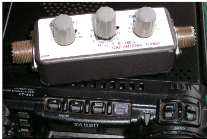
Une boîte de couplage de plus. Sa particularité est d'être minuscule. Il serait difficile de faire plus petit ! Celle-ci est destinée au QRP et peut être utilisée avec notre antenne télescopique universelle décrite le mois passé. Oui, il y aura accord, même sur 80m ! Sinon, il est similaire au Mini coupleur décrit dans QSP n°6 de décembre 2010 (disponible sur [www.on6nr.be](http://www.on6nr.be) et [www.on6ll.be](http://www.on6ll.be))
