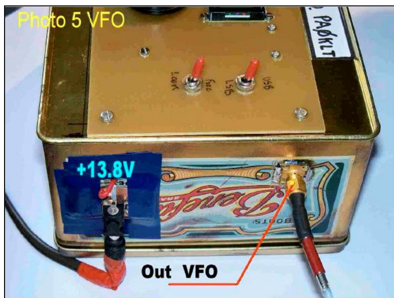
Photo 5 détail de la sortie HF par prise SMA du synthétiseur V.F.O. PA0KLT (ou autre BNC etc.), également la prise alimentation 13,8V.
