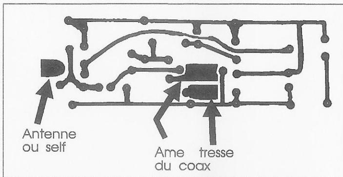
Figure 4 : le câblage du circuit imprimé
