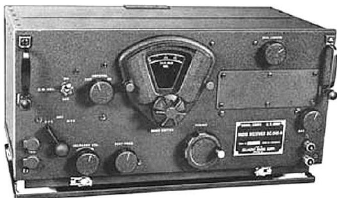
simple générateur qui injectait une porteuse dans la chaîne moyenne fréquence pour pouvoir entendre le CW. Pour cela, il fallait couper l'AGC et régler manuellement (via un simple potentiomètre) le gain de toute cette partie du récepteur. On pouvait aussi démoduler la SSB mais c'était assez acrobatique car il fallait être pile sur la fréquence.
