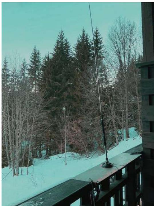
L'antenne sur le balcon est une ground plane télescopique KOMUNICA HF-PRO2-PLUS T, ajustable du 80 au 2 m.
