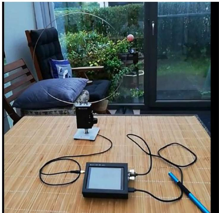
Cette version (qui ne sera pas la dernière !) est la Microloop dont les selfs enfichables ont été remplacées par une seule self, monoboucle de +/-35cm en fil d'aluminium, et destinée à être facilement transportable dans un "bagage de cabine" pour les vacances.
