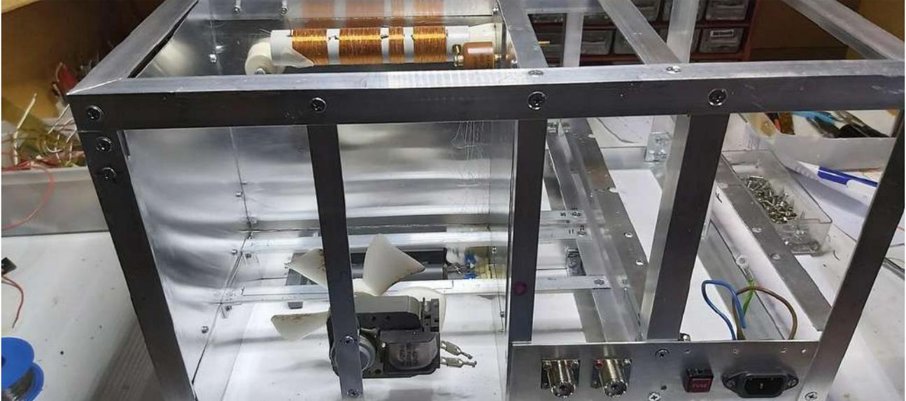
Le ventilo (micro-onde) le panneau arrière (2xPL, fuse, 220V) manque le phone jack pour la commande E/R
