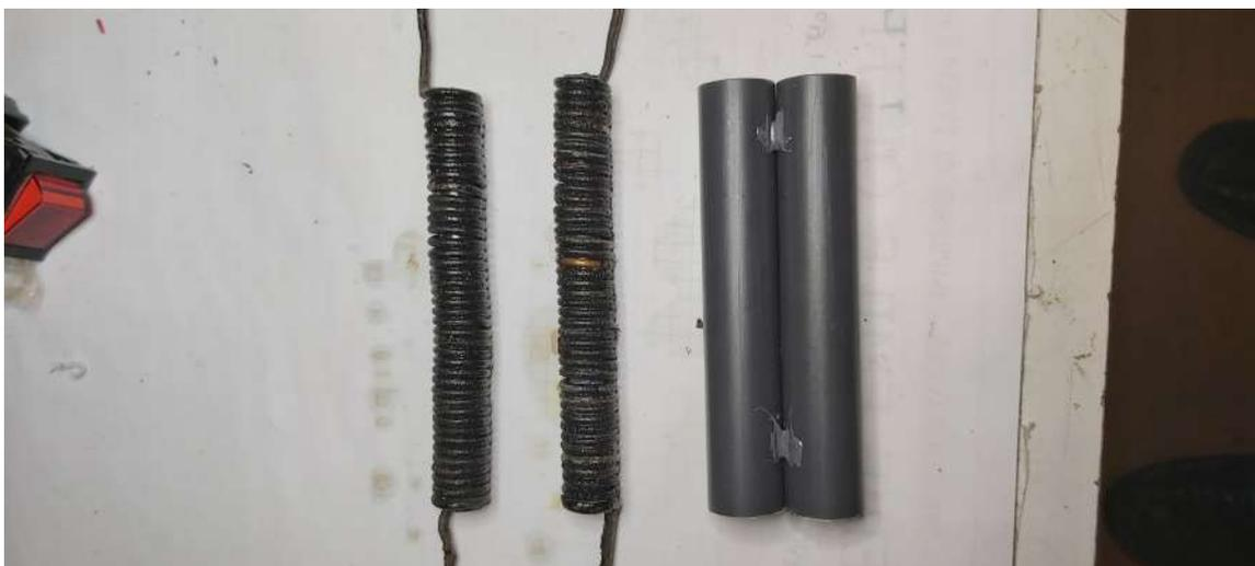
On voit ici les deux selfs filament en 4 carrés, ça n'a pas fière allure mais c'est du fil monobrin enrobé de fibre, pas de PVC. Ensuite vernis. Dedans, deux grandes ferrites. Elles sont placées dans des tubes en PVC pour un montage facile.
