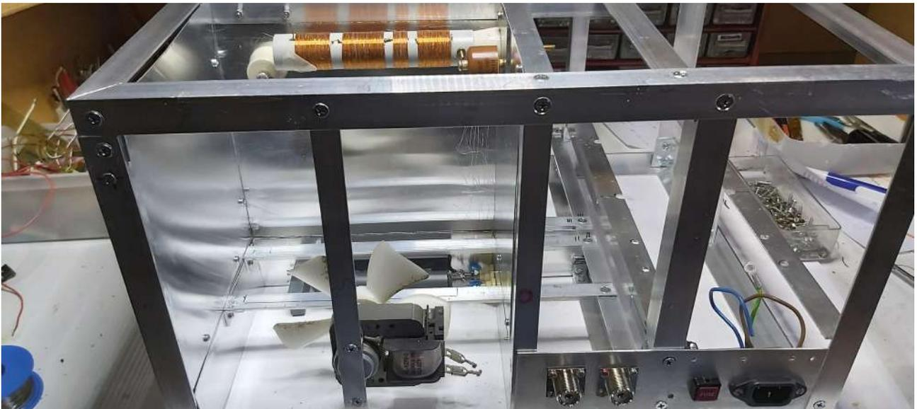
Vue arrière, le compartiment "tubes" est fermé à l'intérieur. En-dessous, ce sera la tôle d'habillage et derrière, il y aura un trou pour le ventilateur. Au-dessus une découpe est prévue pour l'extraction d'air. C'est un ventilateur de micro-ondes, le problème du bruit n'est pas encore 100% résolu mais pour ce qui est de refroidir... j'ai placé deux bocaux à confiture avec de l'eau bouillante dedans, ça refroidit... et vite !
