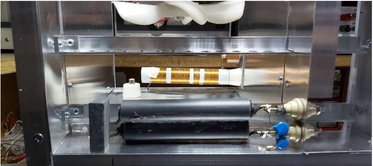
Vue par dessous. On voit la self d'arrêt HF, construite par moi, copie conforme "Collins"
