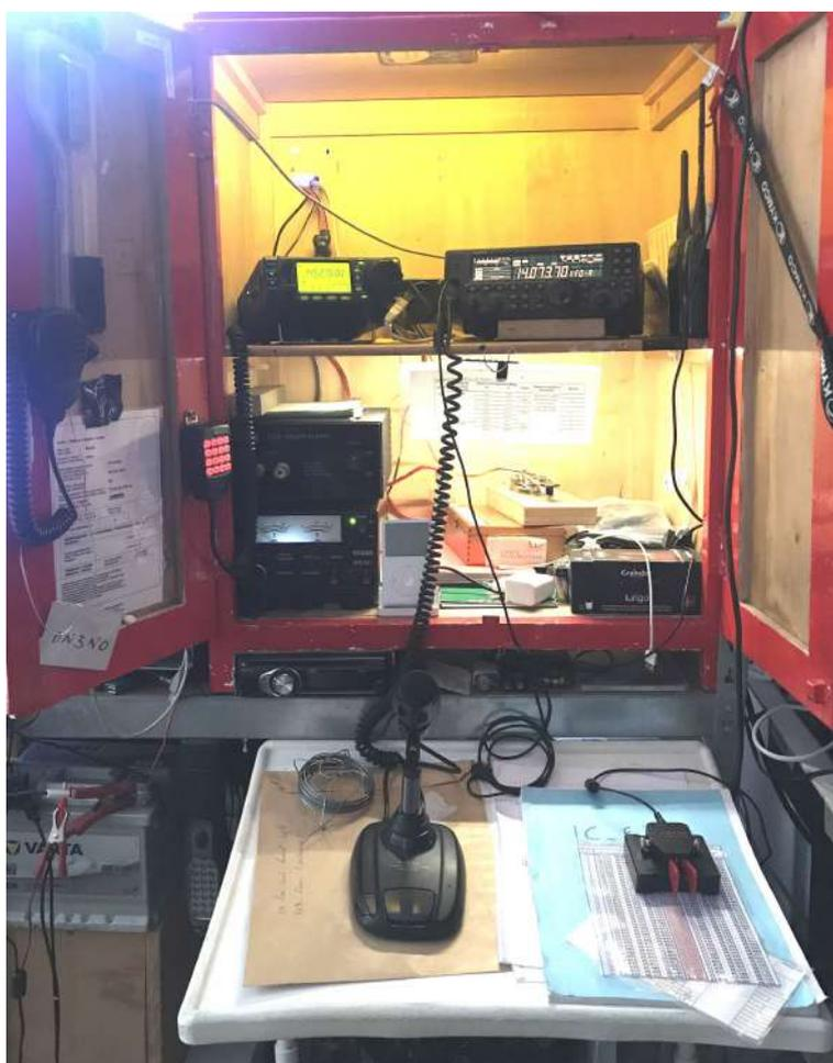
Compacte car à l'échelle d'un appartement mais intelligemment conçue. Il y a des idées à prendre... Remarquez la clé morse à côté du superbe micro Yaesu MD-100... Quant à l'antenne, il s'agit d'un long-fil de 30m avec transfo 9:1 en HF et une verticale et une beam en VHF-UHF. Cela est suffisant pour avoir un log-book bien rempli et avec des QSO de qualité !
