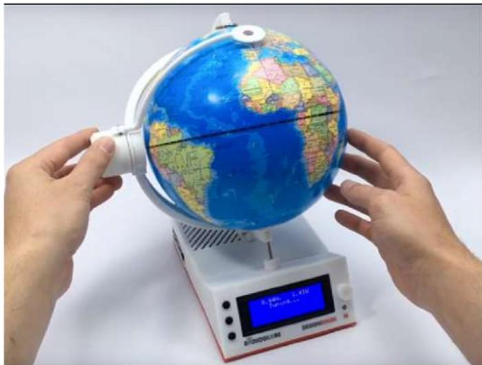
Le principe est simple : deux encodeurs optiques servent d'axes au viseur et ce sont eux qui sélectionnent la station correspondante à l'endroit "visé".
