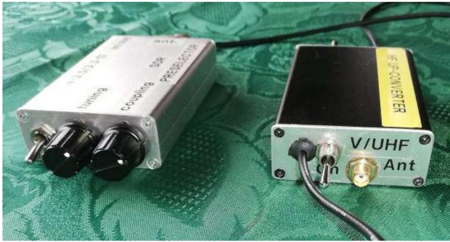
A gauche : la face avant du coupleur-présélecteur que nous décrirons dans un prochain numéro. Il couvre de 3 à 30MHz en trois gammes, à l'aide d'un simple commutateur « à zéro central » et de deux CV polyvaricons miniatures.
