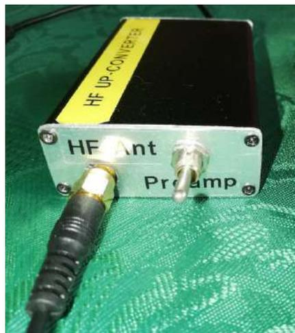
La face avant du convertisseur : la prise antenne et le switch du préampli.
