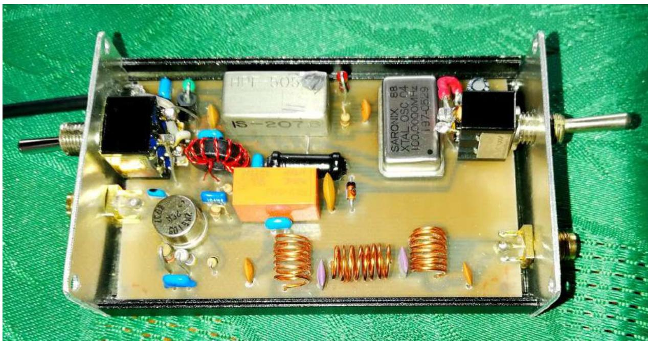
La version précédente avec l'oscillateur à 100MHz et la self L4 moulée (la verte en haut, à gauche avec sa perle en ferrite).
