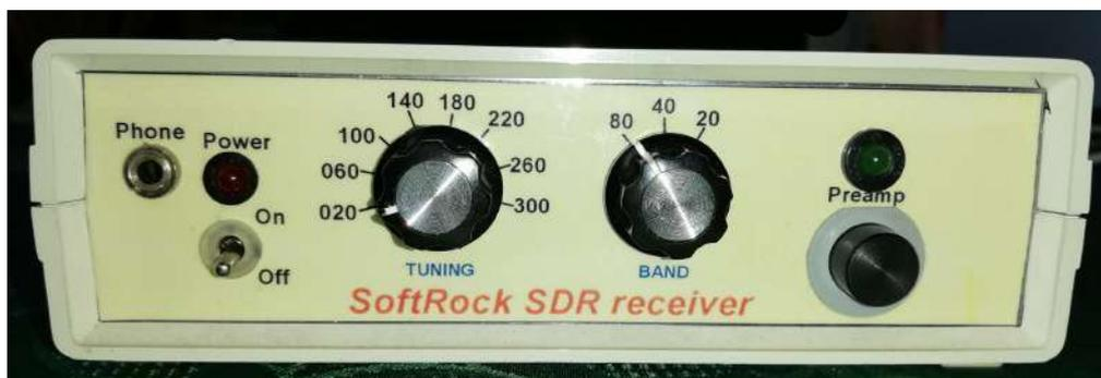
La face avant. Comme d'habitude, impression couleur sur un papier normal qui est ensuite plastifié puis doublé d'un papier collant double face pour être collé sur la face avant réelle qui est en alu de 1mm.
