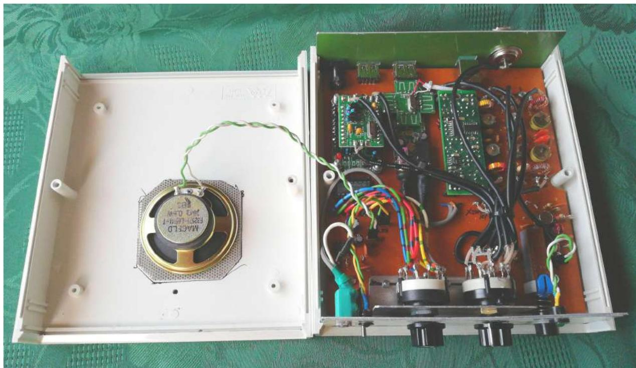
L'intérieur. Ici, tout est monté et il est fonctionnel à 100%. Le préampli HF donne un gain de 24dB et consomme 14mA.
