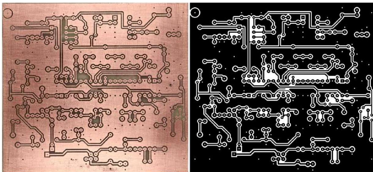
**Détail :** Voici un extrait du circuit imprimé. Les pads (pastilles) ont un diamètre de 1mm et les lignes qui en partent mesurent 0,4mm. Vous pouvez en apprécier la netteté. Il peut sembler y avoir une certaine irrégularité, c'est dû aux effets de la lumière sur les traces de ponçage lors de l'enlèvement du toner. On est ici à une échelle de moins de 100 microns !
