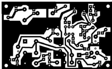
*Et voici le calque vu du côté composants (donc à travers l'époxy). On l'imprime sur un calque et le toner sera au contact du cuivre. Celui-ci est à l'échelle 1:1.*
