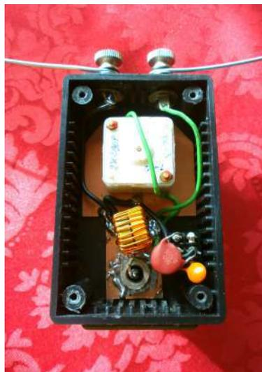
Vue du montage. A droite, le switch et ses deux condensateurs
