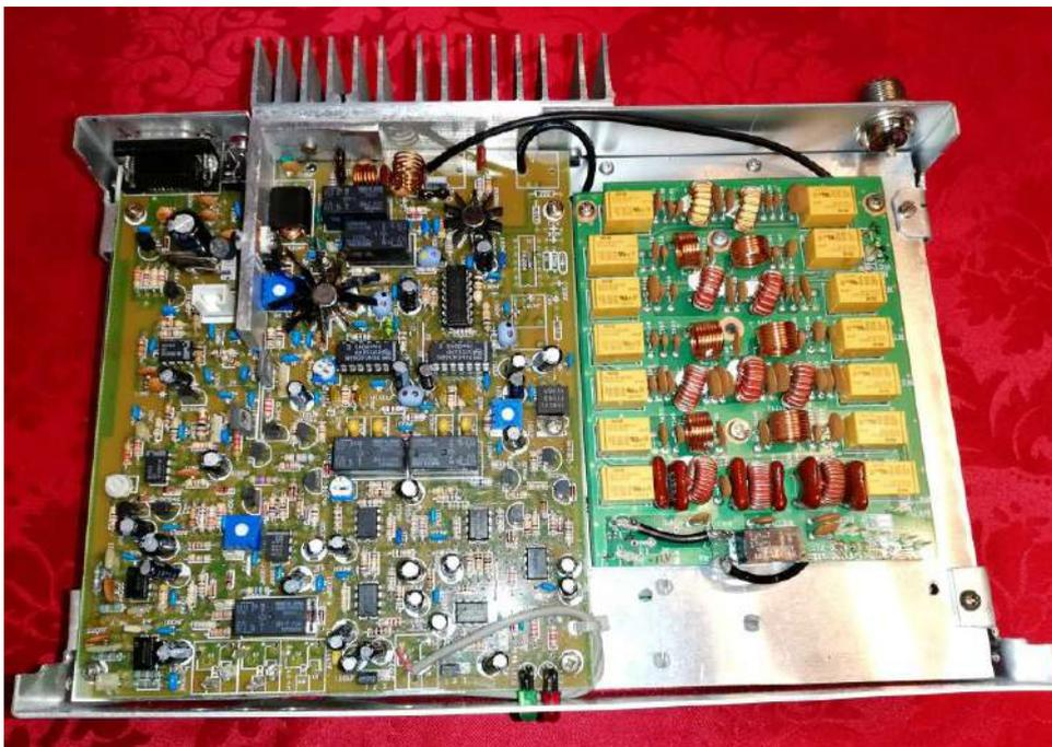
*Il est-réalisé sur une platine en alu et les PCB's sont placés des deux côtés. A gauche, le PCB de l'AVALA proprement dit. Il est muni d'un PA (IRF510) pouvant délivrer ~5W A droite, une platine filtre passe-bas récupérée sur un TS-870 défunt. L'équerre en alu sert à transférer la chaleur du PA qui se trouve à gauche du transistor en boîtier TO39 muni d'un grand refroidisseur à ailettes (noires). Comme je veux en tirer au moins 20W*
