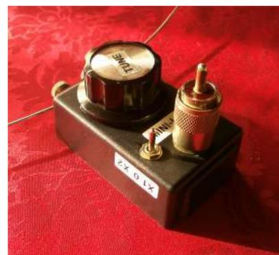
La mini-loop vue de côté. La PL259 est vissée par un réducteur pour RG58 et des rondelles ajustées au plus serré sont intercalées
