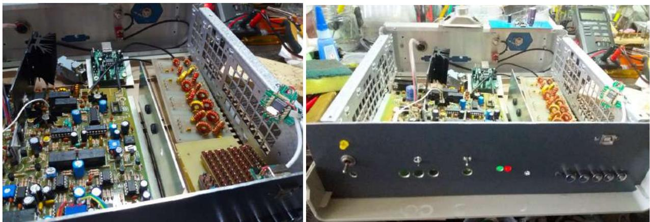
Il est aussi très avancé. A gauche, on peut voir la platine du TRX et le gros refroidisseur du PA. Tout à l'arrière, le PLL QRP-Labs et, à droite, le filtre passe-pas. Il est de conception 3ALL et commandé par un clavier à bouton poussoirs pour couvrir les 10 bandes du 160 au 6m. Tout à
