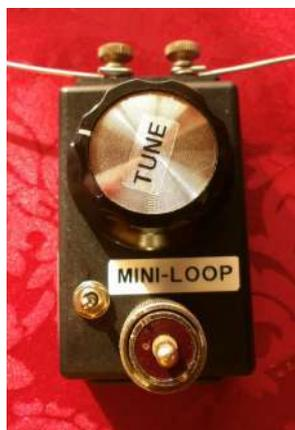
La mini-loop vue de face. A gauche, le sélecteur de capacité
