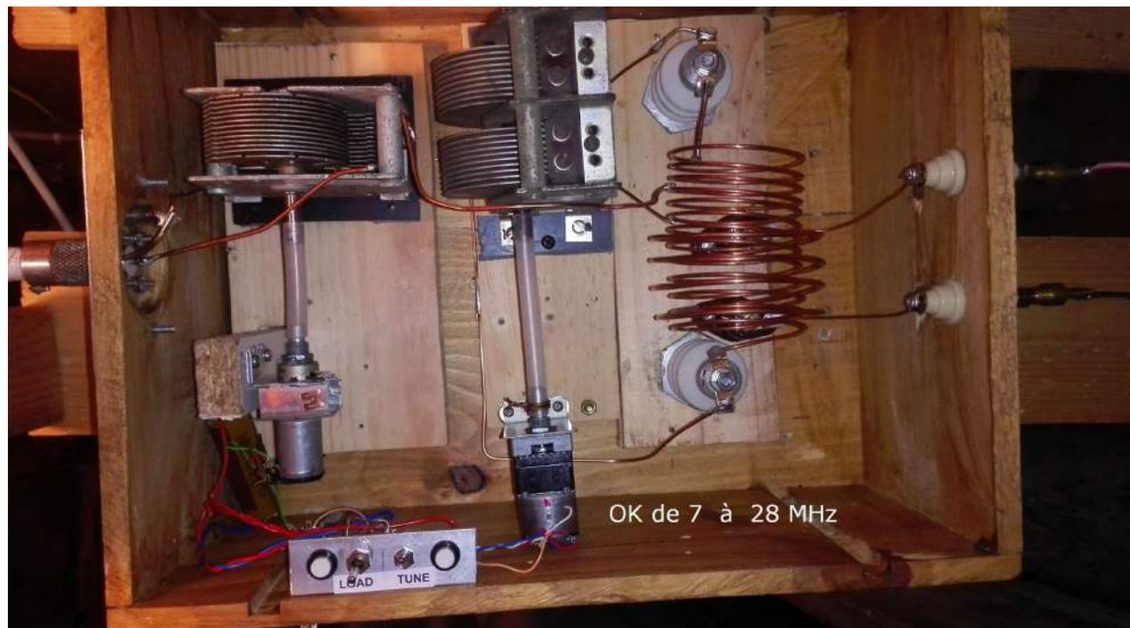
La self d'accord est réalisée en gros fil de cuivre. Celle de couplage utilise un fil identique mais su un diamètre plus important. Sortie sur des isolateurs en porcelaine vernie.
