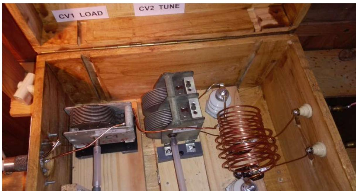
Les CV sont des récup de BCR à lampes des années 50 et avant. C'est donc le gros modèle qui est utilisé. Les rallonges d'axe sont en plastique.
