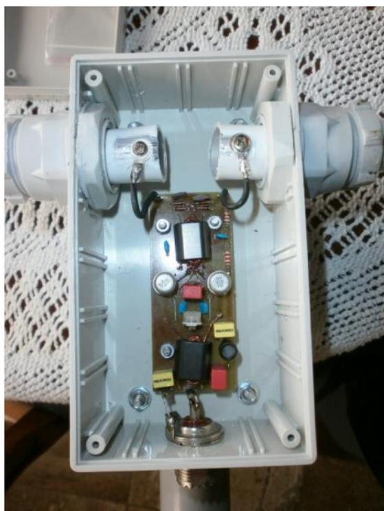
fonctionne très bien à l'intérieur, est directionnelle (pratique pour éliminer les stations ou sources de bruit gênantes) et a un gain élevé. Elle fonctionne de 30KHz à 30MHz et est très bon marché en réalisation OM. Son rendement équivaut à la célèbre "long-fil" de 16m20 pour le décimétrique au dessus du 80m mais est largement supérieure à tout ce qui se fait comme antennes filaires classiques en dessous du 80m. Elle est un must pour le 160m !
