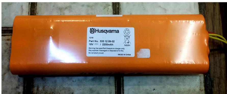
Ce sont des packs de 15 éléments. Donc il suffit d'en enlever 3 et vous avez une batterie de 14.4 v / 2.200 mA/h.
