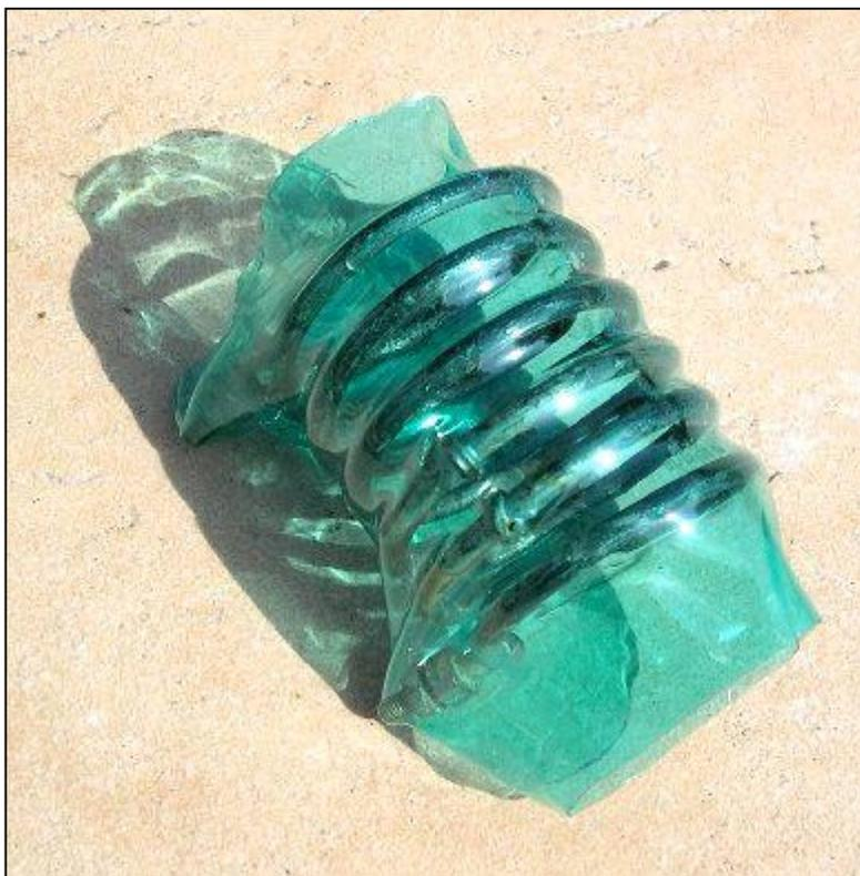
Ces flacons sont obtenus industriellement en gonflant un tube en plastique, chauffé
