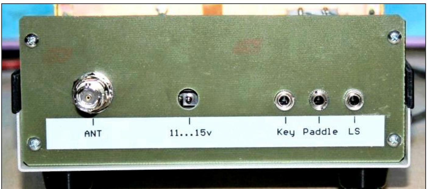
Prérégler CA1 et CA2 à mi-course, P3 à fond dans le sens contraire des aiguilles d'une montre. Brancher une antenne accordée sur la bande des 40 mètres et remettre sous tension. Pot2 à fond, il doit y avoir du souffle dans le haut-parleur (ou le casque).
