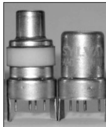
1° Le « Westector » est un redresseur cuivre/oxyde de cuivre spécialement conçu pour la détection des signaux HF.
