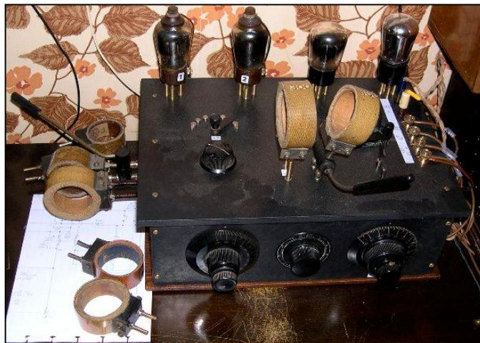
Voici un autre récepteur mode 1920. A réaction, bien entendu. On réglait celle-ci ainsi que le couplage des primaire-secondaire du transfo HF en rapprochant les selfs. Celles-ci sont d'époque. Elles sont munies de longs leviers à manche d'ébonite afin de limiter l'effet de main lors de la manœuvre.
