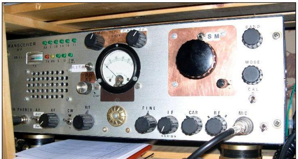
En effet, le VFO est accordé à l'aide d'une varicap. Cela signifie une commande en tension par un potentiomètre multitours. Le galvanomètre mesure simplement cette tension et son aiguille dévie donc conjointement avec la variation de fréquence. Le gros bouton noir sur un fond de cuivre est celui du VFO. Le petit switch qui y est accolé (au dessus) sélectionne la
