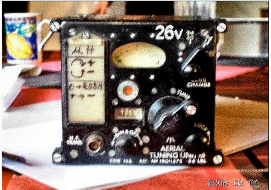
Le coupleur -ou plutôt "la boîte d'accord". La commande de la self à roulette répertoriée "Tuning". Un bouton marqué "DIM Off sert à diminuer le rétroéclairage. Le bouton marqué "Lock" sert à bloquer la self à roulette pour qu'elle ne se dérègle pas en vol suite aux vibrations et aux chocs.
