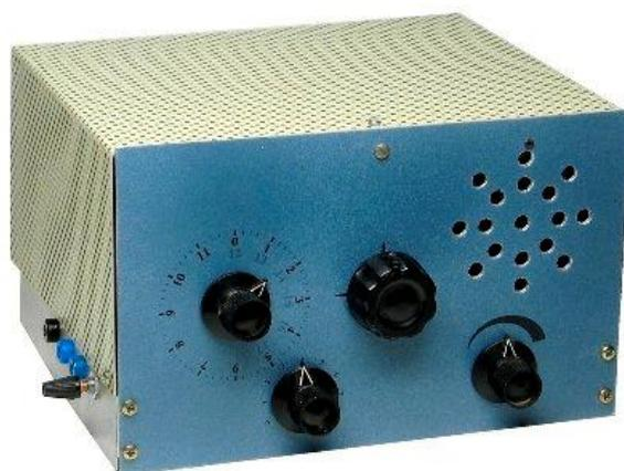
**4XEL84 - Récepteur Ondes Courtes à Réaction**
