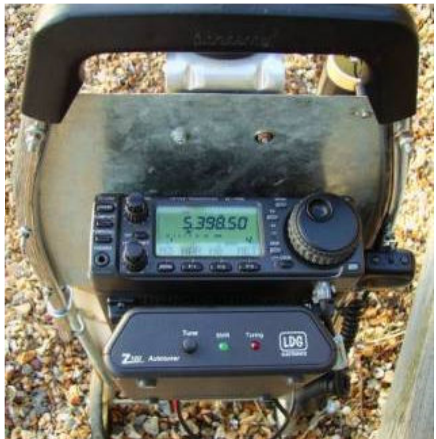
[FIG 3] Une petite longueur de coax connecte la verticale à un tuner automatique LDG Z100
