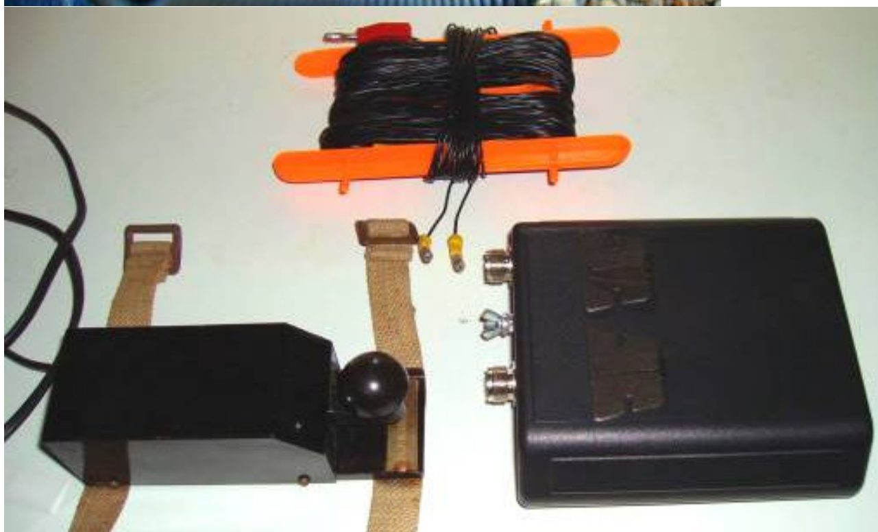
[FIG 5] Les radiales sont stockées sur un planchette destinée à servir d'enrouleur à une ligne de pêche au crabe. La clé morse issue de la dernière guerre mondiale que j'utilise pour le trafic en CW et que je sangle autour de ma jambe. A droite : le coupleur automatique.
