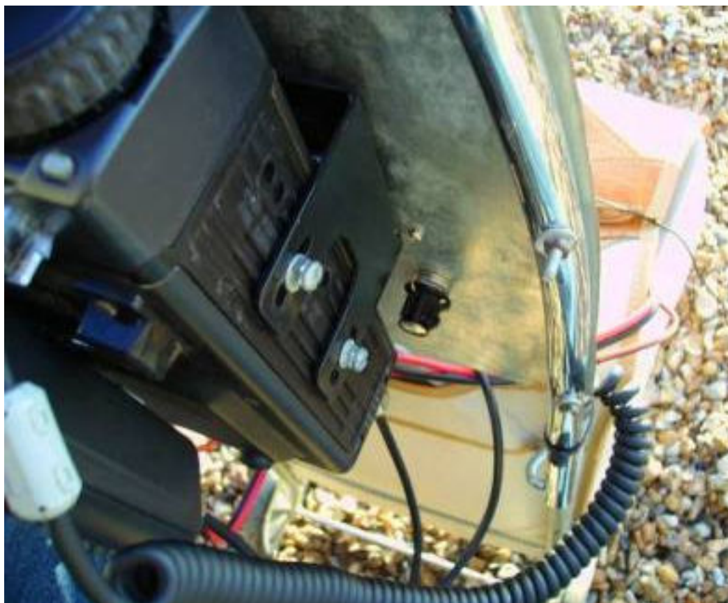
[FIG 6] Vue de la fixation de l'IC706. Le bouton commande le CV situé de l'autre côté de la plaque d'aluminium.
