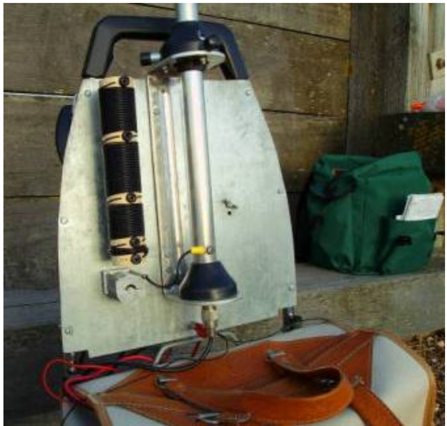
[FIG 3] Une petite longueur de coax connecte la verticale à un tuner automatique LDG Z100
