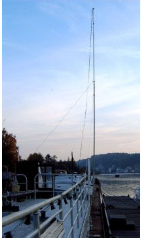
Vue de la Fély vers l'avant : le mat et son haubannage sommaire. L'antenne est une Lévy avec boîte de couplage.
