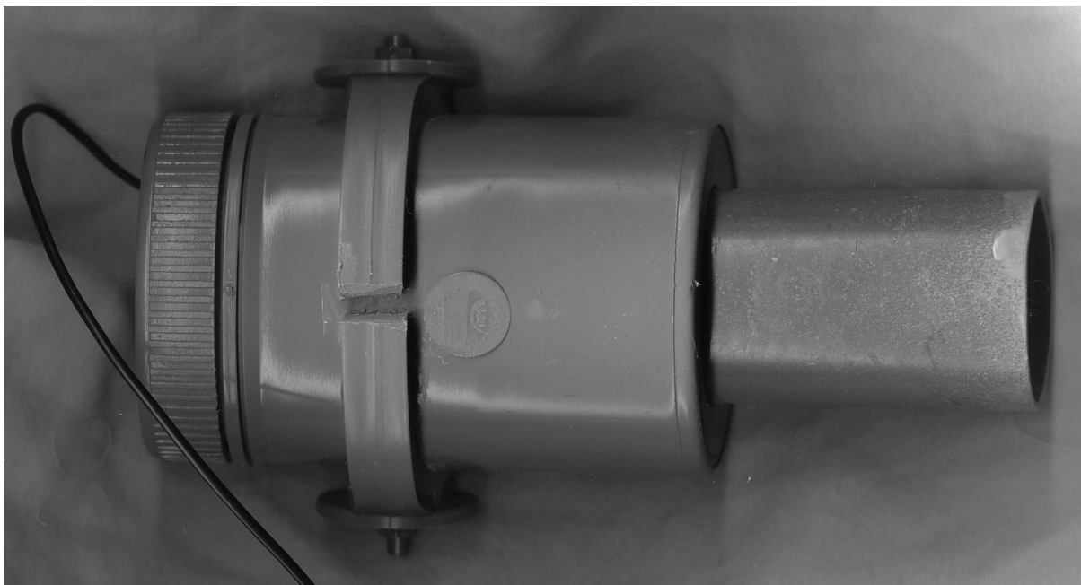
Photo du haut-parleur terminé mais non peint et sans sa bride et son socle.
